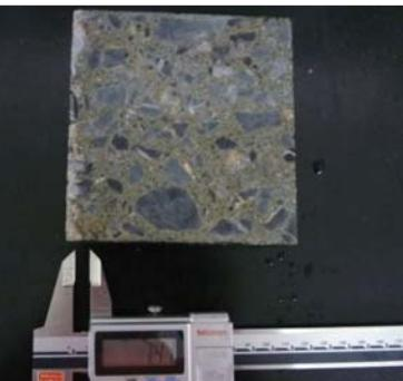
塩化物イオン浸透試験で塗布面
